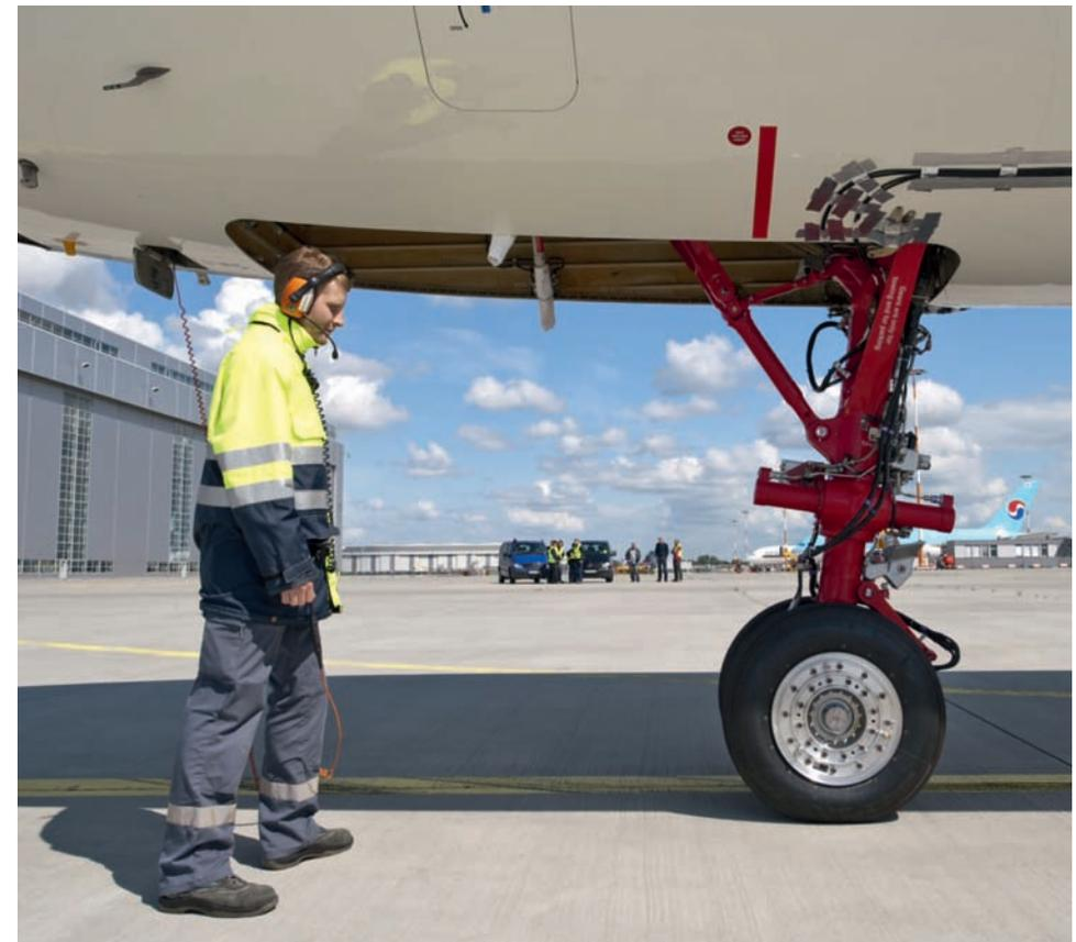
trieb ist die kompakte Form. Das Volumen der A320-Originalfelge durfte nicht überschritten werden. Bei den Motoren selbst handelt es sich um permanent erregte, getaktet angesteuerte Gleichstrommotoren. Einfach aufgebaut und mit einer hocheffizienten Steuerelektronik ausgestattet, könnte diese Motorenart später kommerziell genutzt werden. Mit einem Zielgewicht von 65 Kilogramm pro Motor fällt das Zusatzgewicht des Antriebs moderat aus.
